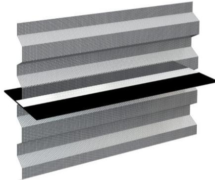
recostal® 1000 F - Abschalelement mit Fugenblech zur Herstellung von Arbeitsfugen in WU - Betonkonstruktionen von Sohlplatten, Stahlbetonwänden und in Decken.
