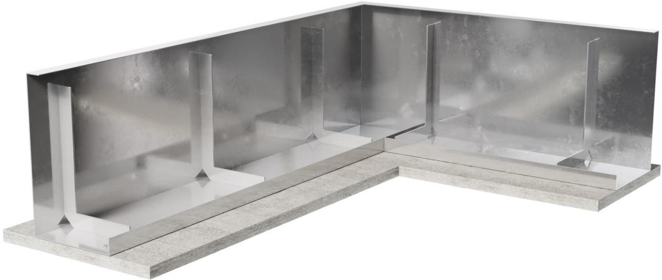
Die recostal<sup>®</sup> Randschalung ist eine innovative Lösung aus verzinkten Stahlblechen für Bodenplatten und Geschossdecken. Die Elemente sind in Standardlängen von 2,25 m und in Höhen von 14 cm bis 50 cm selbsttragend erhältlich.
