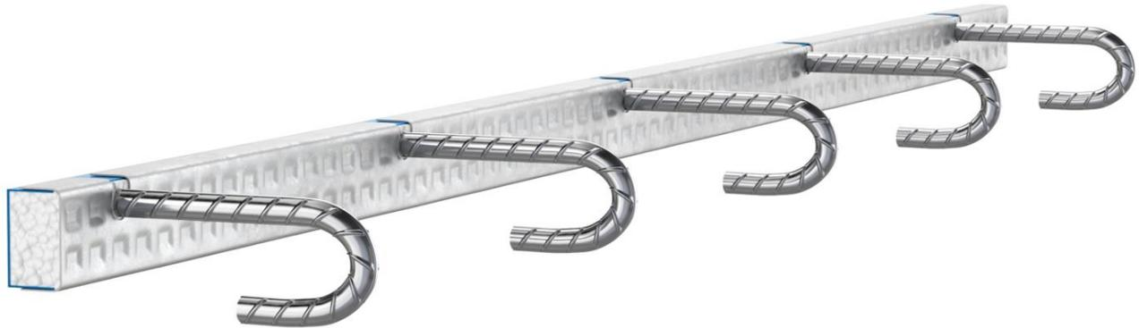
Der recostal® Bewehrungsanschluss Typ V besteht aus einem noppenprofilierten Verwahrkasten aus verzinktem Stahlblech. Als einreihiger Anschluss ist er variabel für alle Bauteilbreiten einsetzbar. Der recostal® Typ V Bewehrungsanschluss ermöglicht eine einfache und sichere Verbindung von Stahlbetonbauteilen unterschiedlicher Betonierabschnitten.
