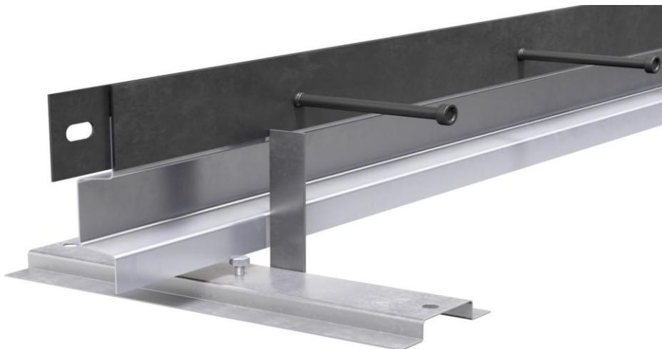
Das RECOSTAL® Keyboard-Profil XLV/XLW dient zur Abschalung von Trennfugen in Hallenböden und Fahrbahnplatten mit planmäßiger Rissbildung in der Fugenlinie. Oberer Fugenabschluss mit Kantenschutz aus Flach- oder Winkelstahl (Ausführung schwarz, feuerverzinkt oder Edelstahl möglich) zur Verhinderung des Ausbruchs der Betonkanten. Die Variante XLV-D und XLW-D stehen für Dämmung und verfügen über eine 1 cm Trennplatte aus Styropur für Hallenböden und Fahrbahnplatten.
